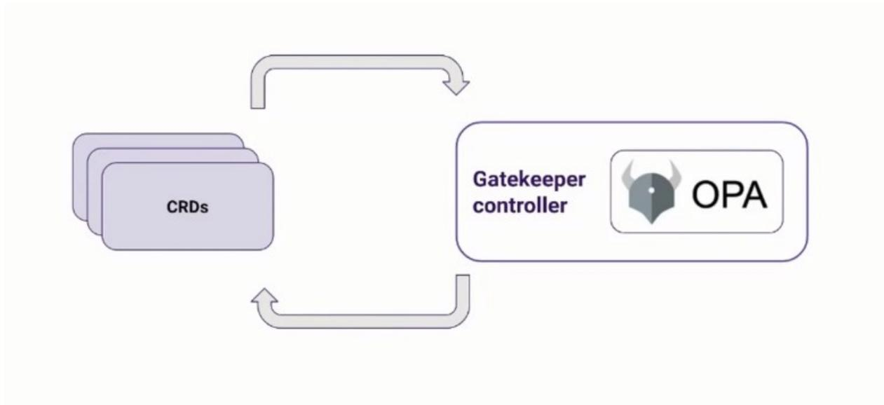
Gatekeeper es un plugin primitivo, completamente diseñado para kubernetes, ya que crea nuevos objetos para la API de kubernetes mediante CRDs y un controller que hace el “Reconciliation Loop” (Esto sirve para conducir el estado actual hacia el estado deseado).
